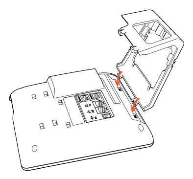
B、按箭头方向按压脚架,使脚架的另一边扣进主机底壳的槽内,如下图所示:
