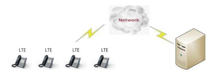
备注: LTE 网络支持通过 LAN 口路由功能,默认 DHCP 网段为 192. 168. 225. X。 直连网线到电脑端,在浏览器输入默认的 IP 地址 192. 168. 225. 1 可以访问话机网页。
