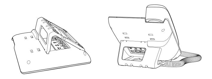
D、如果要拆卸脚架,按下脚架上端弹力片,同时按箭头用力扳脚架,则可取下脚架。如下图:
