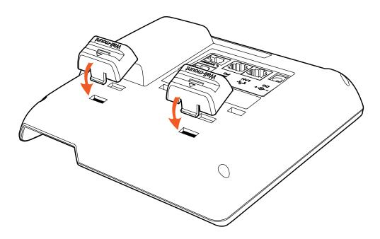
B、按箭头方向按压挂墙脚架,使脚架的另一边扣进主机底壳的槽内,如下图所示:
