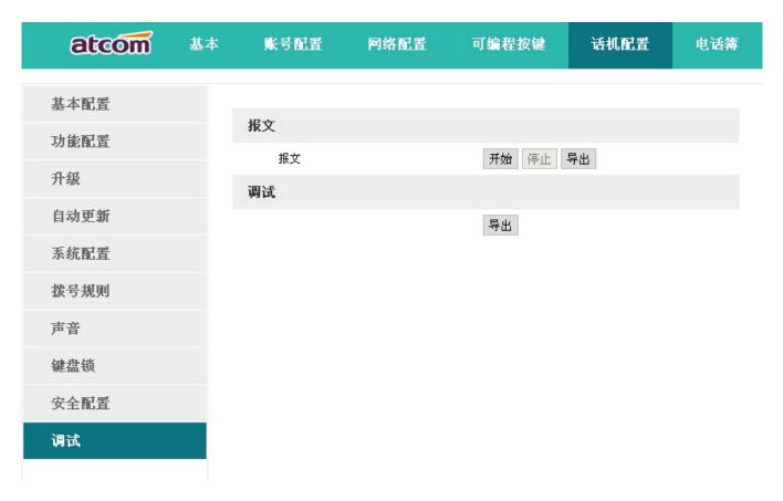
要对话机进行抓包分析,可以点击报文选项中的"**开始**"按钮进行抓包,抓包结束后,按"**停止**"按钮结束抓包,之后通过"**导出**"按钮就可以通过网页下载抓包文件了。
