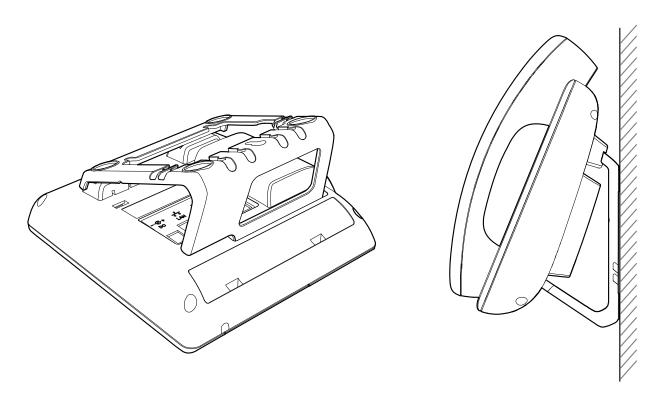
F、拆卸脚架方法:按 Push 箭头方向按下脚架弹力片,同时按旋转箭头方向用力扳脚架,则可取下脚架,分别为 step1、step2、step3 和 step4。如下图:
