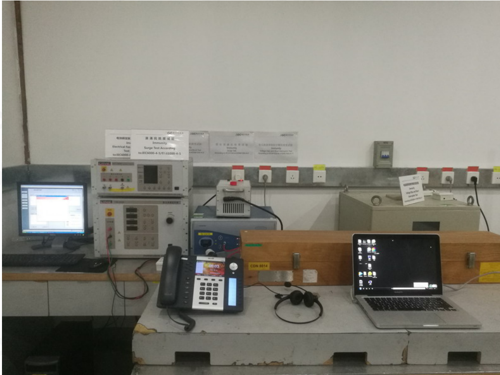
EN 61000-4-3 RS TEST SETUP
